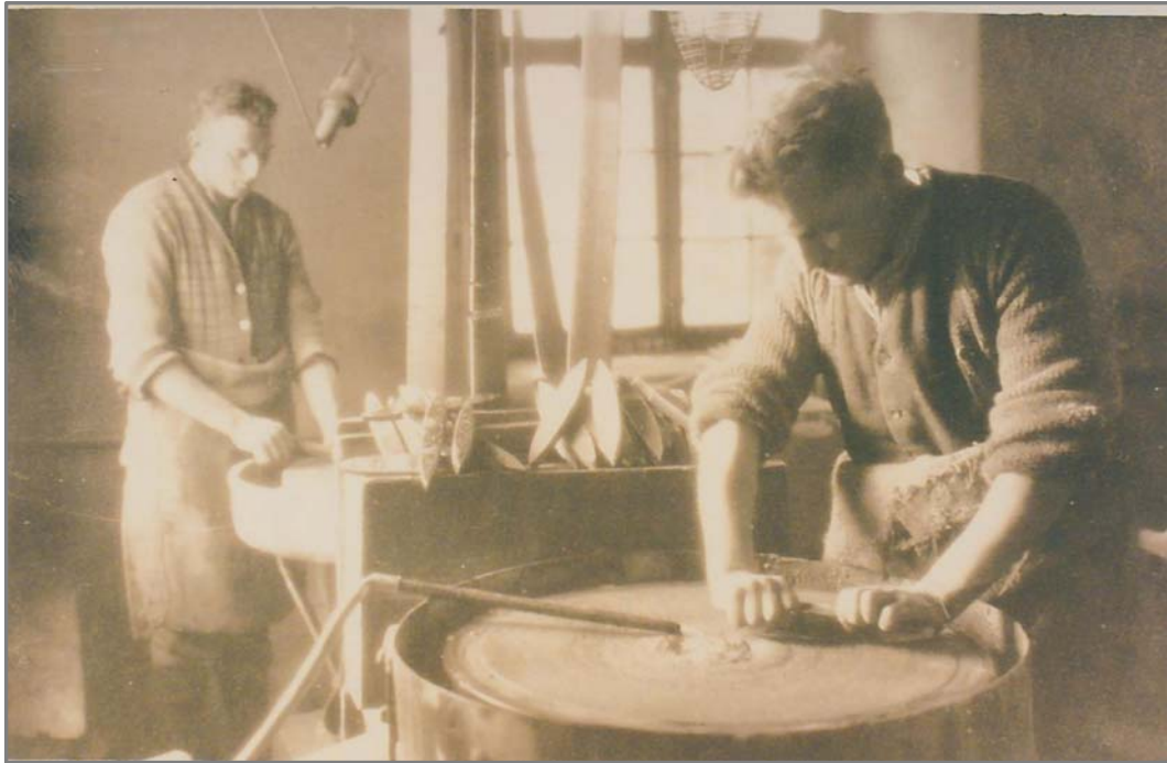
Abb. 31 Handschleifer schliffen die Bruchseiten und Kanten der Rohwetzsteine aus.
